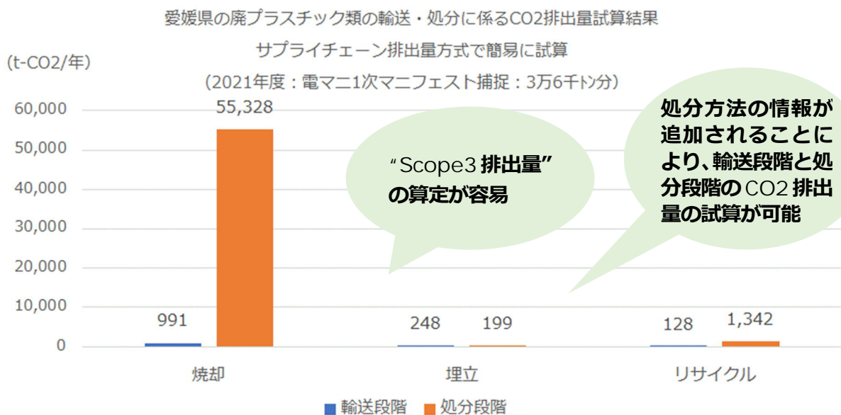
図 3-16 サプライチェーン排出量算定方式に基づく 2021 年の愛媛県の「廃プラスチック類」の処理処分に係る CO2 排出量の試算結果
