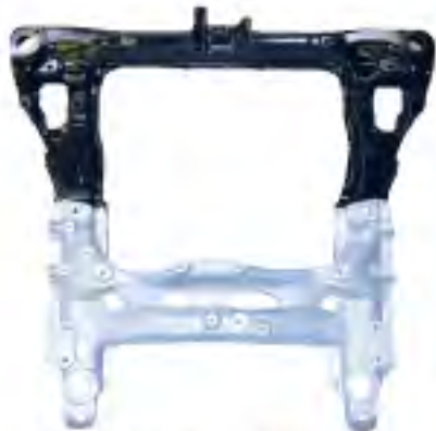
FSWによる異材接合された フロントサブフレーム
