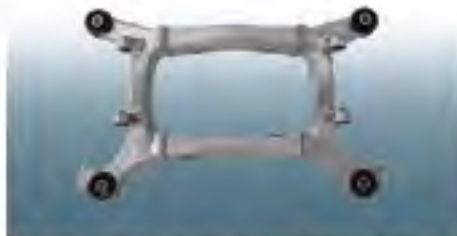
アルミハイブリッド製法による リアサブフレーム
