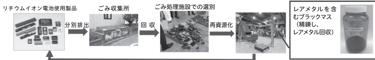
図4 リチウムイオン電池の再資源化の循環図
