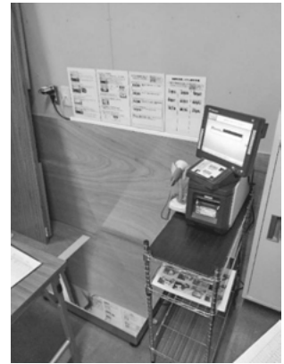
写真2 廃棄物計量機
