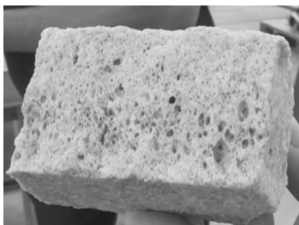
写真3-3 パネル由来のガラスの二次製品（発泡ガラス）
