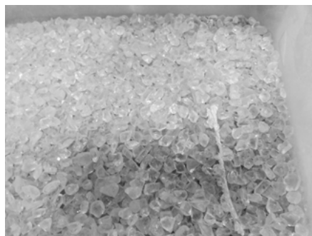
写真3-2 ガラス（破碎ガラス）
