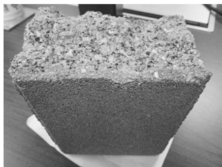
写真4 パネル由来のガラスを含んだシュレッターダストを原料に製造した路盤材
