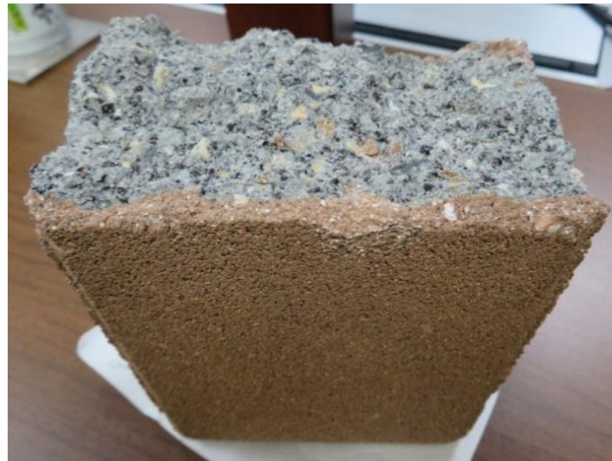
写真4-2 パネル由来のガラスを含んだシュ レッダーダストを原料に製造した路盤材
