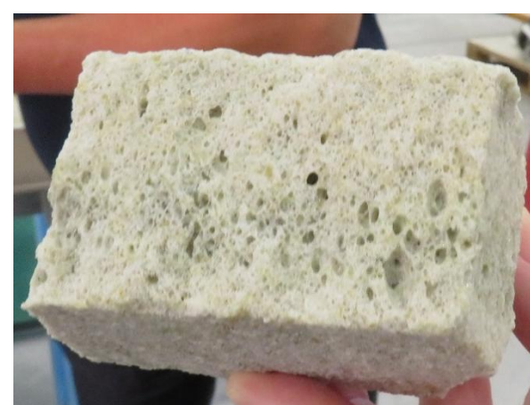
写真3-3 パネル由来のガラスの二次製品（発泡ガラス）
