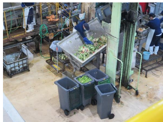
写真4 原料投入状況（生ごみ・飼料化）
