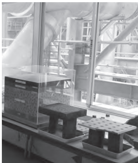
下層路盤材(左)、吸水実験できる展示物(中央)、点字ブロック(右)
